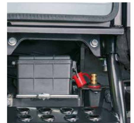
L'AXOS 200 vi facilita il lavoro quotidiano con numerose soluzioni intelligenti come, ad esempio, lo spostamento dei poli della batteria sul lato destro della cabina.
