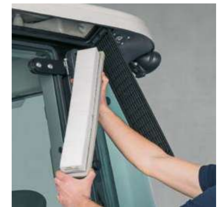
Si può raggiungere facilmente dall'esterno il filtro dell'aria in cabina per pulirlo ed avere sempre aria fresca e pulita.
