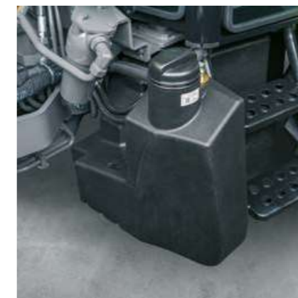
Il serbatoio carburante di 105 l e il serbatoio per l'urea di 10 l assicurano sempre l'autonomia necessaria anche durante lunghe e intense giornate di lavoro.
