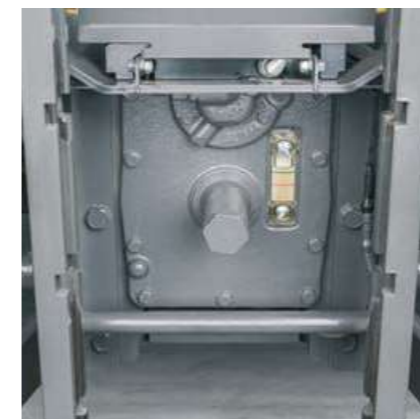
Attraverso un vetro spia posizionato vicino alla presa di forza potete controllare il livello dell'olio della trasmissione e dell'impianto idraulico.
