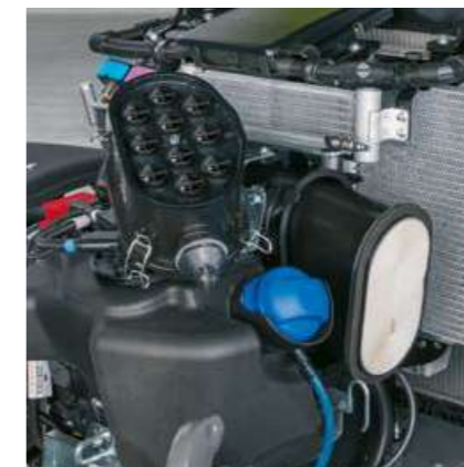
Il filtro dell'aria PowerCore® si trova nella parte anteriore del cofano motore ed è ben raggiungibile. Gli intervalli di pulizia sono minori.
