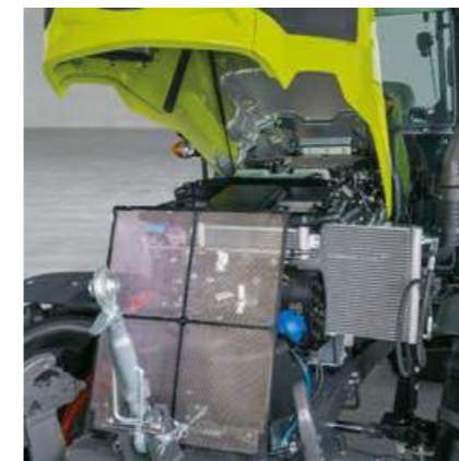
Il radiatore e il filtro possono essere estratti velocemente per un controllo e la pulizia.
