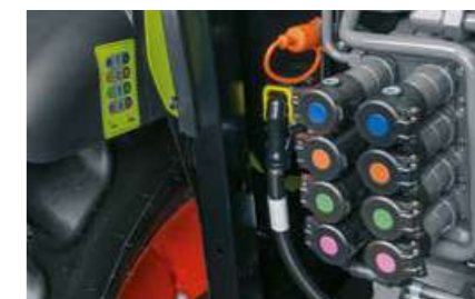
Gli innesti posteriori sono facilmente riconoscibili grazie ai diversi colori e all'etichetta applicata nelle vicinanze.
