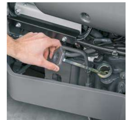
È possibile controllare il livello dell'olio e rabboccarlo a cofano chiuso sul lato destro dell'AXOS 200.
