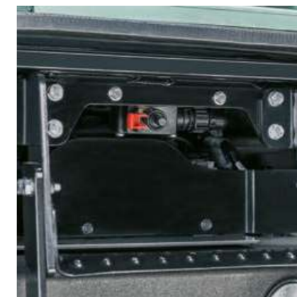
Lo stacca batteria è facilmente raggiungibile a sinistra della scaletta d'accesso.
