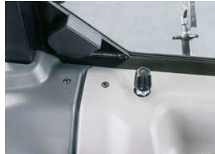
La portata massima del distributore meccanico n. 3 può essere limitata con una manopola in cabina.
