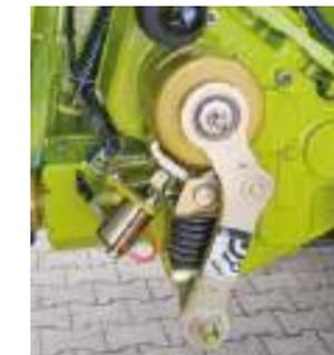
Frizione di disinnesto del rilevatore di metalli.
