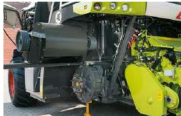
Semplice montaggio e smontaggio dell'acceleratore.
