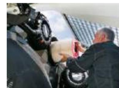
Sostituzione senza attrezzi del filtro dell'aria.
