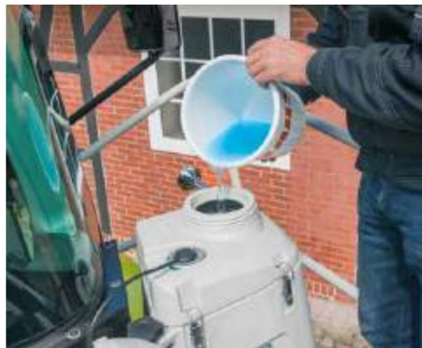
Riempimento del serbatoio additivi.
