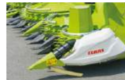
Punta lunga per mais allettato ad azionamento idraulico.
