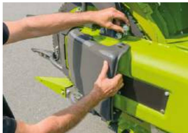
Slitte con regolazione dell'altezza su due livelli.
