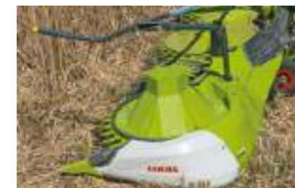
Il grande cono per mais allettato ottimizza il flusso di prodotto e impedisce che il prodotto rimanga sui dischi di trasporto.
