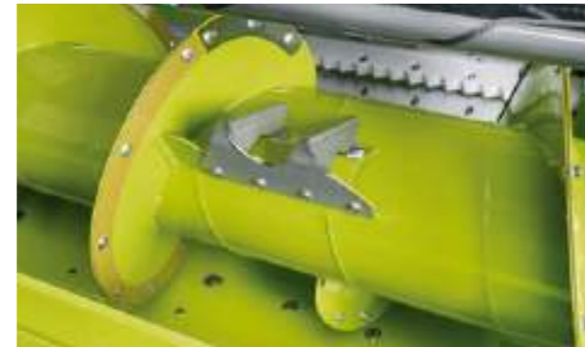
Coclea convogliatrice con diametro di 600 mm per capacità produttive elevate.
