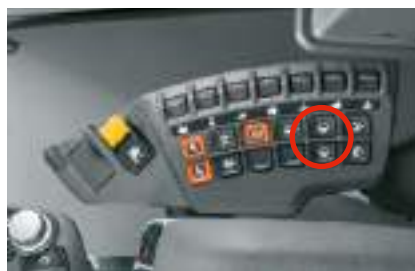
Un solo interruttore per l'intero processo di ribaltamento.
