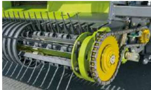
Robusto raccogliatore per una raccolta pulita del foraggio.
