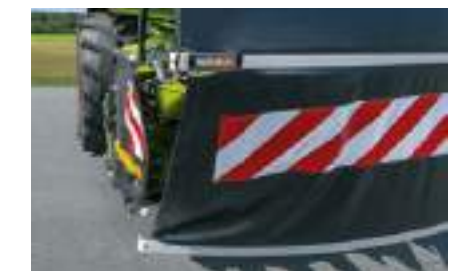
Le protezioni laterali e la protezione anteriore sono ben visibili grazie alle applicazioni adesive di segnalazione. L'illuminazione a LED è totalmente integrata.
