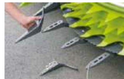
Le dita convogliatrici smontabili migliorano la raccolta del mais allettato.
