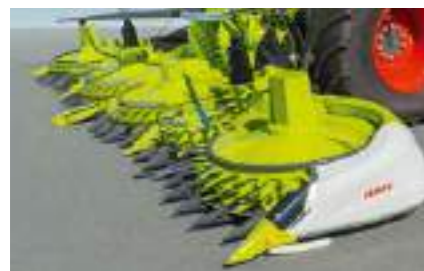
Struttura molto piatta per stoppie basse.
