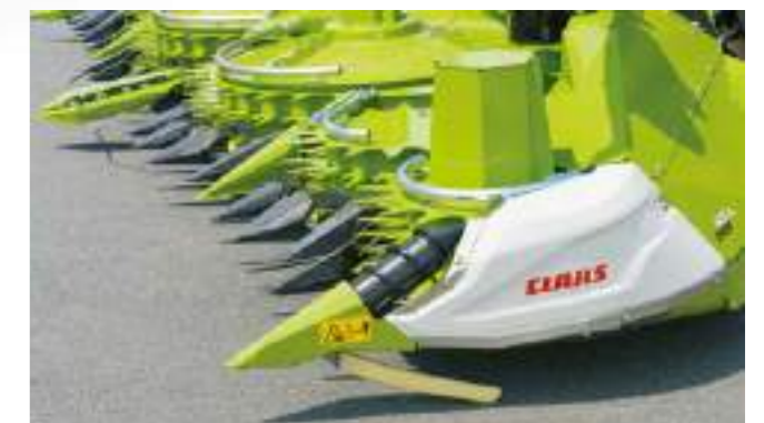
In caso di necessità, la trasmissione delle coclee per il mais allettato avviene idraulicamente.
