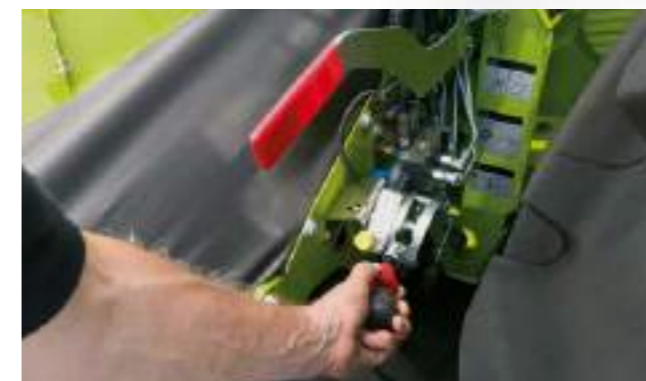
Regolazione della velocità dei tamburi di alimentazione su tre livelli per un flusso di prodotto ottimale.
